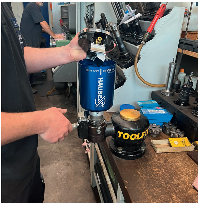
5 Das Rüsten der Haubex-Einheit mit dem Rohteil ist im Handumdrehen erledigt © Hanser
